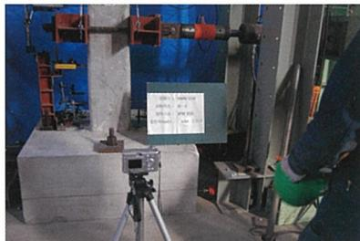
**5** せん断破壊試験状況
