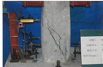
**6** せん断破壊試験状況
